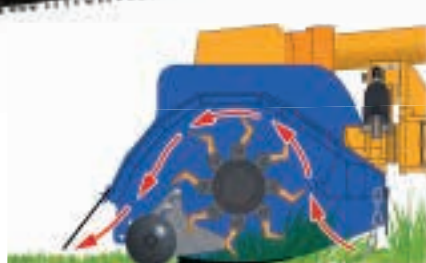
Scarico posteriore al rullo: meno potenza richiesta Rear discharge to the roller: less power required Ablage nach der Laufwalze: Weniger Kraftbedarf Descarga trasera del rodillo: menos potencia requerida Déchargement arrière au rouleau: moins de puissance nécessaire
