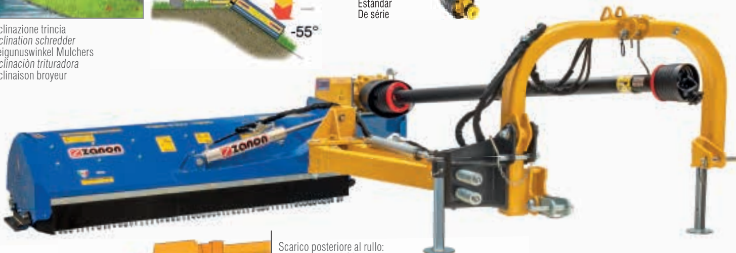
Scarico anteriore al rullo: migliore trinciatura Front discharge to the roller: better shredding Ablage vor der Laufwalze: Bessere Zerkleinerung Descarga frontal al rodillo: mejor trituración Déchargement antérieur au rouleau: meilleur broyage
