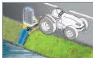
Inclinazione trincia Inclination schredder Neigungswinkel Mulchers Inclinación trituradora Inclinaison broyeur
