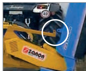
Freno di sicurezza per trasporto su strada Safety pin for road transport Sicherheitsstift für den Straßentransport Pin de seguridad para el transporte por carretera Pin de securite pour le transport routier
