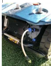
Système de charge de batterie en hiver pour une charge directe sur le robot, sans station de charge
