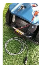
Système de charge de batterie en hiver pour contacts externes, pour charger directement sur la batterie, sans station de charge
