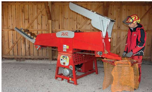
Splitomat avec rotative d'ensachage 3 sacs de 40 L
