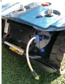
Winter batterijlaadsysteem voor rechte reeks opladen aan de robot, zonder laadstation
