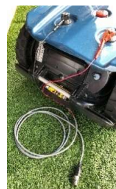
Winter batterijlaadsysteem voor externe contacten, voor rechte reeks opladen aan de batterij, zonder laadstation
