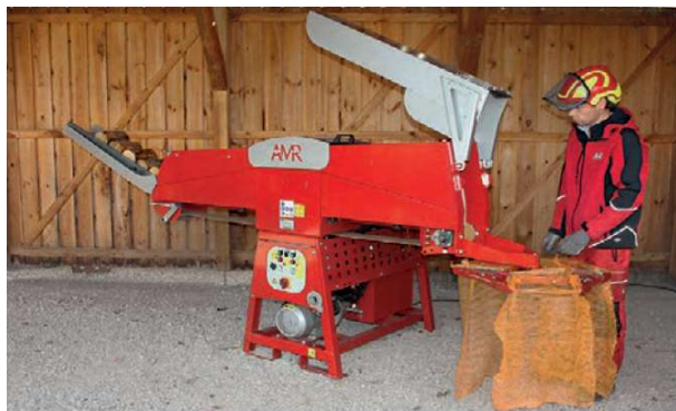
Splitomat met afzaksysteem 3 zak van 40 L
