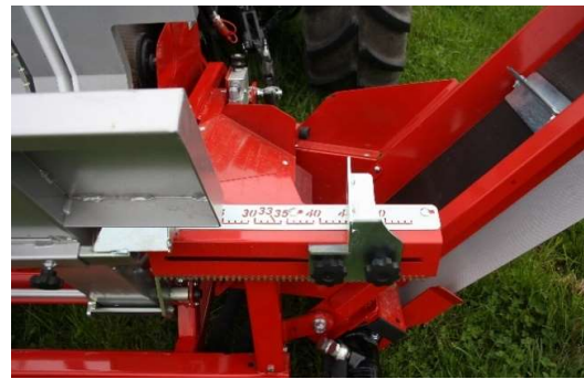
Zaaglengte regelbaar van 20-50 cm, zonder hulpmiddelen
