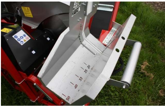
Invoerschuij te zagen hout, met ronddraaiend ergonomisch handvat en veilige afdekkap
