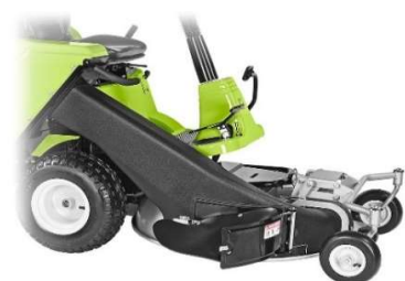
FD220R met zijuitwerpklep (optie)
