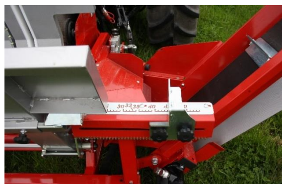
Zaaglengte regelbaar van 20-50 cm, zonder hulpmiddelen
